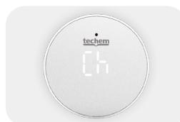
Vous désactivez le contrôle manuel en activant le système de verrouillage.
