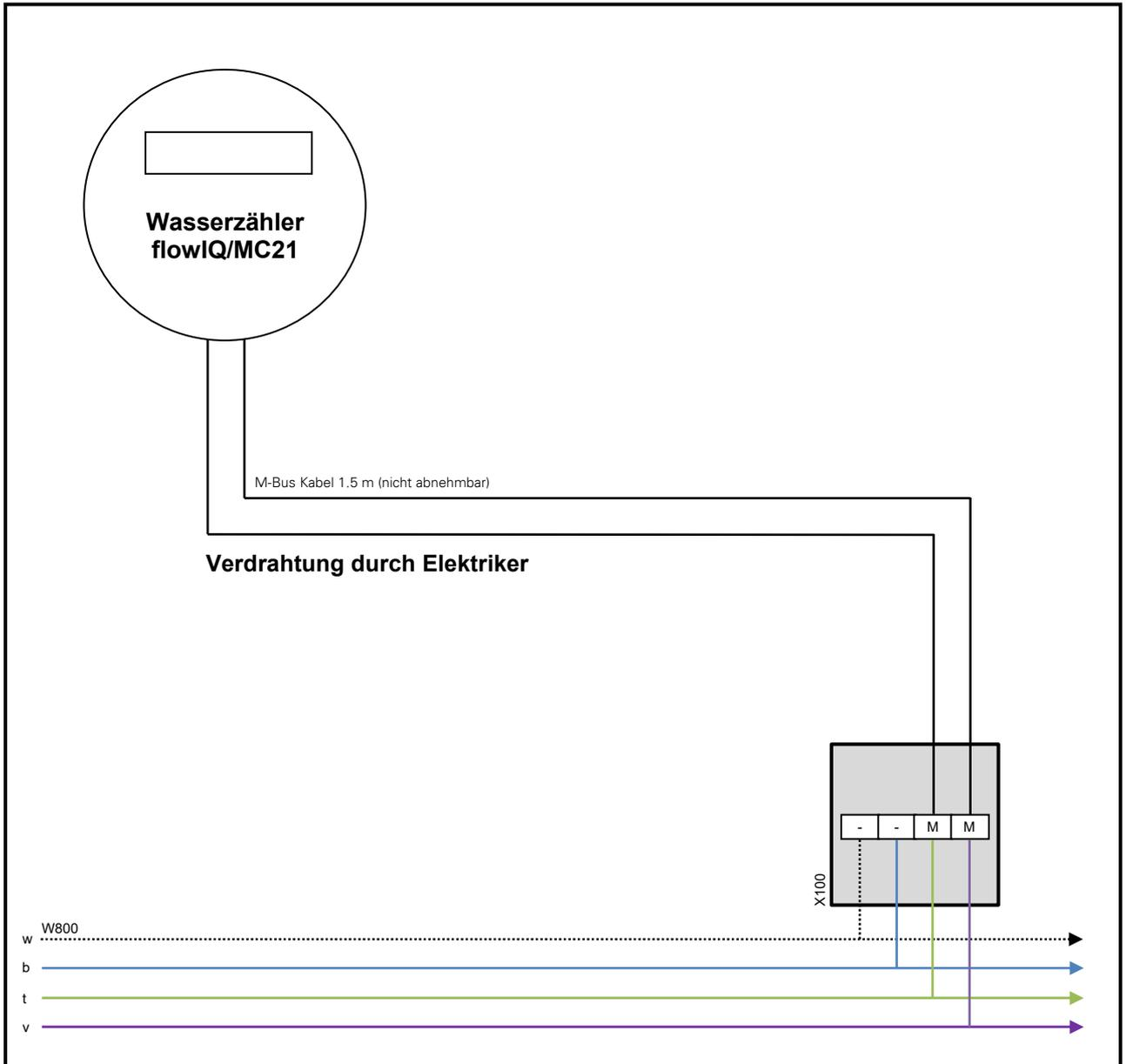
Für die Verbindung bei Unterputzzählern sind zwingend Einzeladerverbinder Scotchlok zu verwenden (nicht lösbar).
