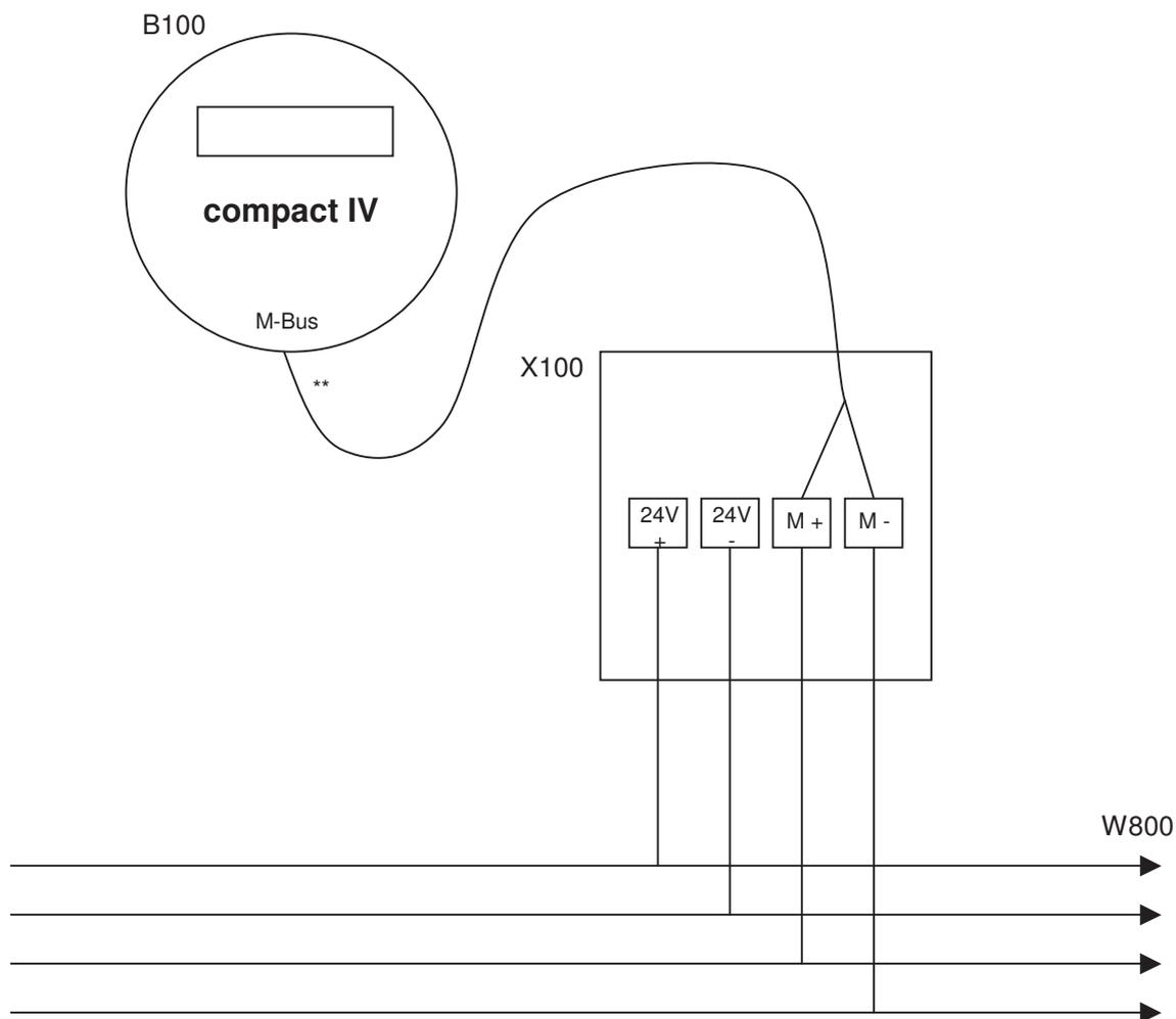
B100 Wärmehzähler compact IV M-Bus
