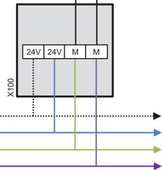
Pour connecter des compteurs encastrés, utiliser impérativement des câbles monoconducteurs Scotchlok (non détachables).
