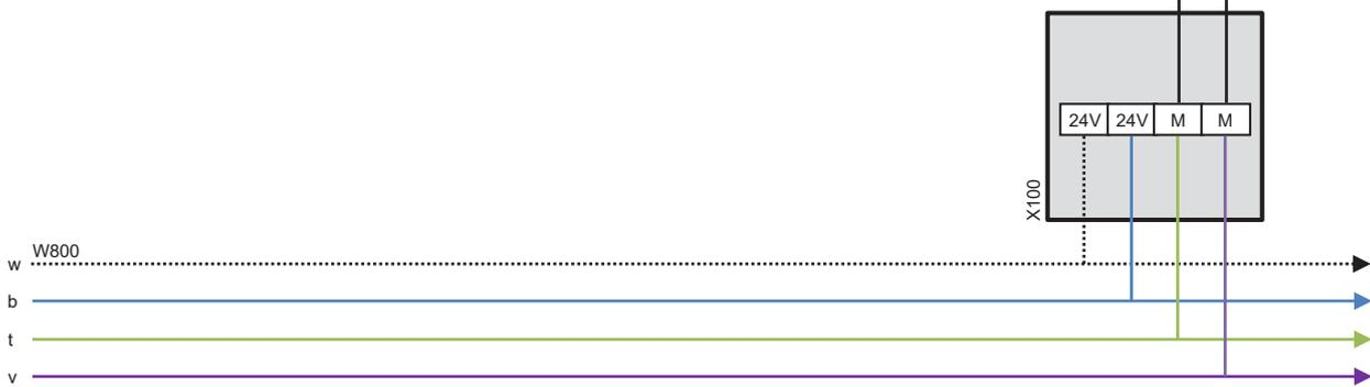
Pour connecter des compteurs encastrés, utiliser impérativement des câbles monoconducteurs Scotchlok (non détachables).
