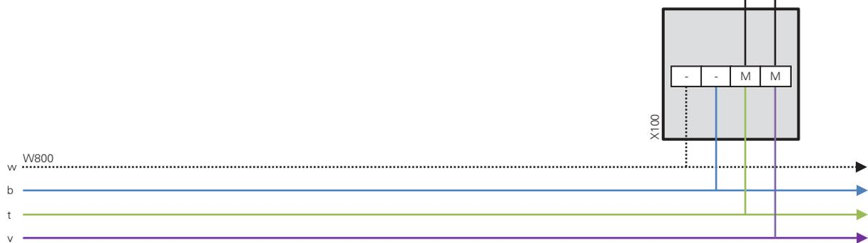
X100 AP (montage apparent) Boîte de jonction plombable (p.ex. Woertz 78x78mm)
