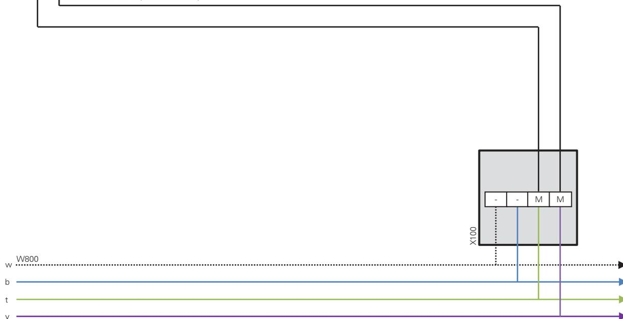
X100 AP Boîte de jonction montage apparent plombable (par ex. Woertz 78x78mm)
