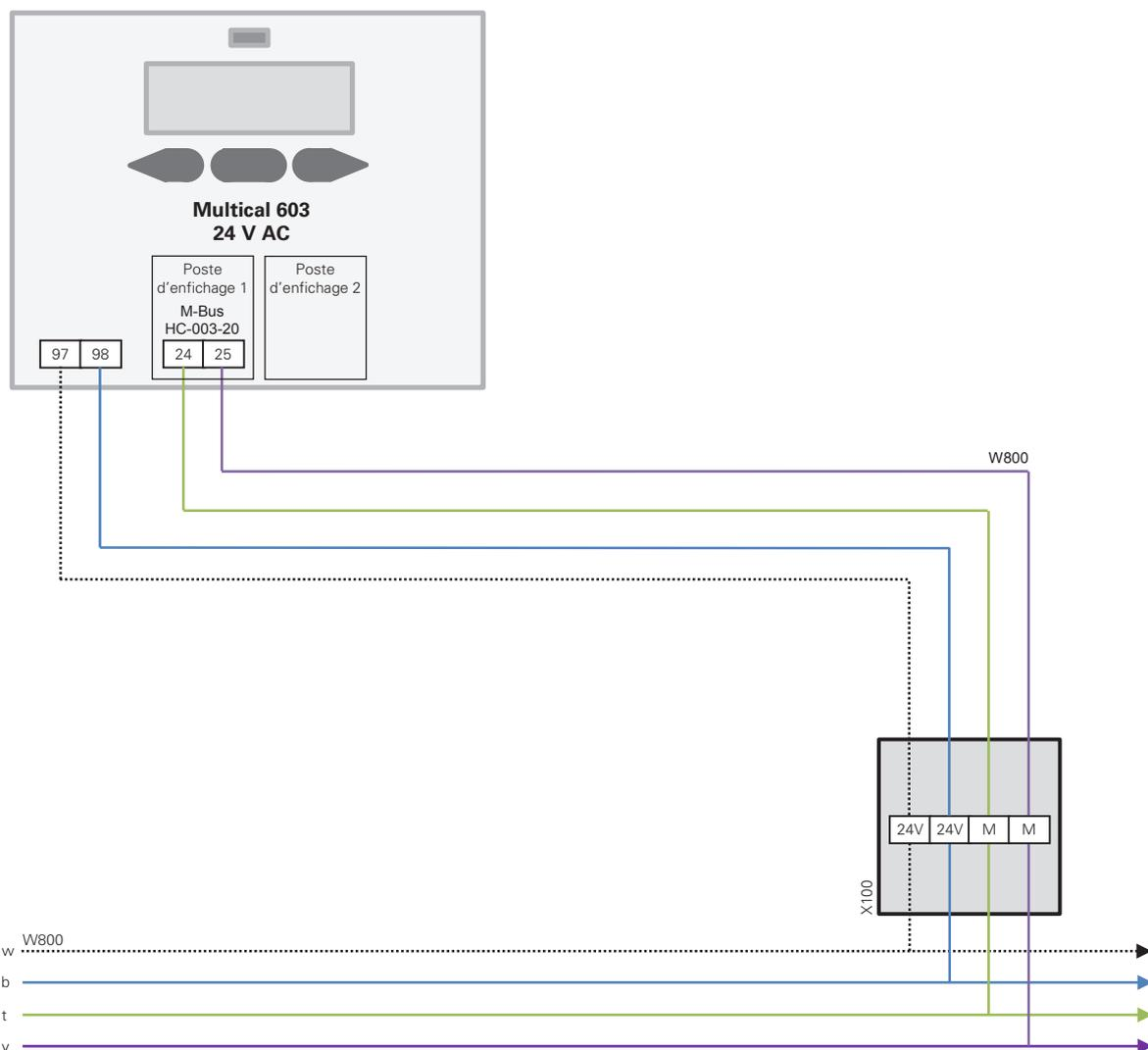
X100 AP (montage apparent) Boîte de jonction plombable (p.ex. Woertz 78x78mm)
