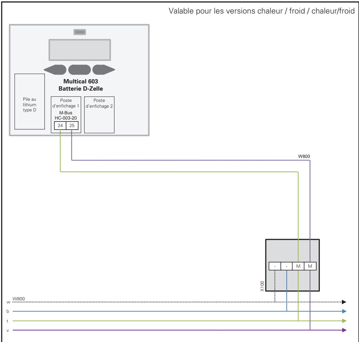
X100 AP (montage apparent) Boîte de jonction plombable (p.ex. Woertz78x78mm)
