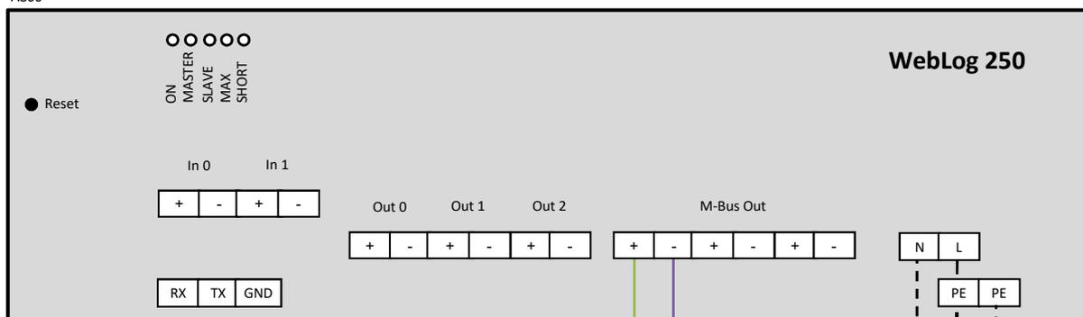
**Affiches LED dans le compartiment de raccordement**
