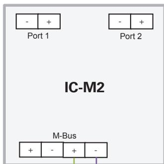
Deux compteurs d'impulsions avec sorties libres de potentiel peuvent être connectés à un IC-M2.
