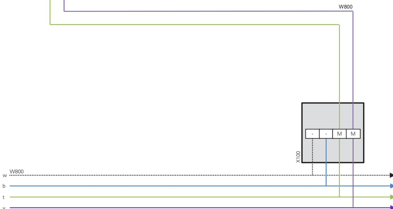
X100 AP (montage apparent) Boîte de jonction plombable (p.ex. Woertz 78x78mm)
