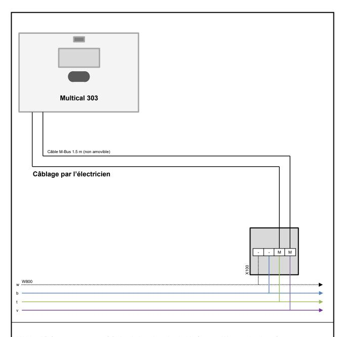
X100 AP (montage apparent) Boîte de jonction plombable (par ex. Woertz 78x78 mm)
