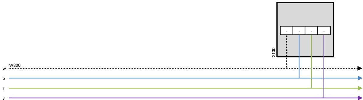
**X100 AP (montage apparent) Boîte de jonction plombable (p.ex. Woertz 78x78mm)**
