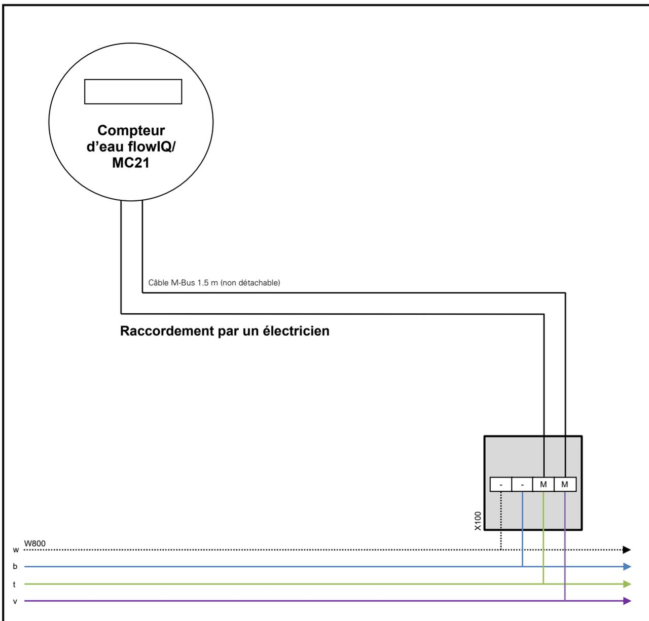
Pour le raccordement des compteurs encastrés, utiliser impérativement des connecteurs monofilaires Scotchlok (non détachables).
