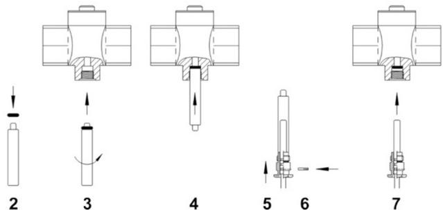
**Montage des capteurs de température dans des poches d'immersion**
