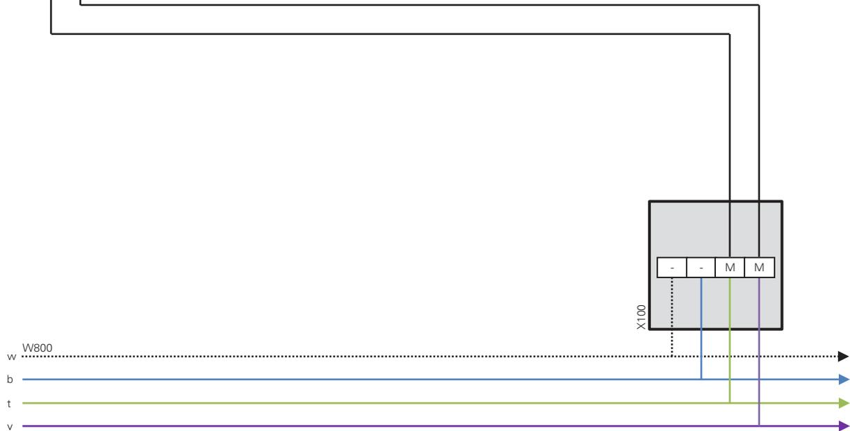
X100 AP (montage apparent) Boîte de jonction plombable (p.ex. Woertz 78x78mm)
