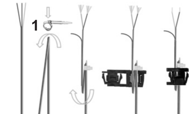
Procédure avec un câble d'émetteur de pulsations fin (1) Serre-câble
