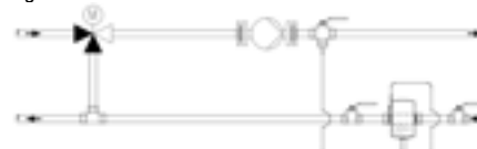
Fig. 3 : Intégration pour circuit avec incorporation ; positionnement des sondes de température
