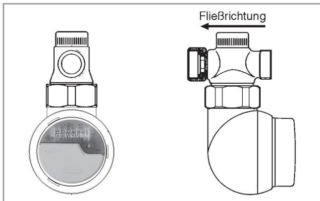
Art.-Nr.: 10 180 011 → Montage z. B. an drucklosen Warmwasserbereitern
