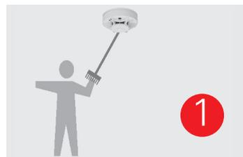
Pulse la tecla del usuario durante **1 segundo** (p. ej., utilizando un palo de escoba).
