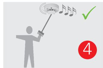
Pulse la tecla del usuario durante **5 segundos**. Cuando suena la **alarma de prueba** (1 s enc./ 1 s apag.), el **detector de humo está operativo**.
