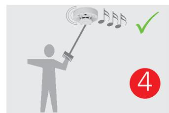
Appuyer pendant env. **5 secondes** sur le bouton d'utilisateur. Si l'**alarme test** retentit (1 sec. marche / 1 sec. arrêt), le **détecteur avertisseur de fumée est opérationnel**. Dans le cas contraire, appeler le plus vite possible l'**assistance téléphonique** gratuite : **08002 001264**.
