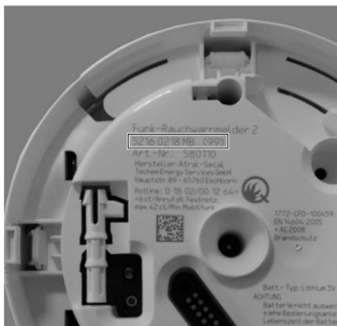
**5** Hãy gắn thiết bị lên mặt lắp ráp bằng cách xoay nhẹ ngược chiều kim đồng hồ và xoay theo chiều kim đồng hồ mà không dùng lực mạnh, cho đến khi khớp vào. Sau khi lắp đặt, thiết bị sẽ tự động trở lại chế độ bình thường. – Có thể kiểm tra mức độ sẵn sàng hoạt động của RWM bằng cách nhấn nút người dùng cho đến khi báo động kiểm tra phát ra.
