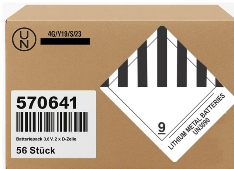
Abbildung 10: Beispiel für Gefahrgutkennzeichnung für UN3090 inkl. Seetransport-Bezeichnung - Eigendarstellung mittels KI erstellt
